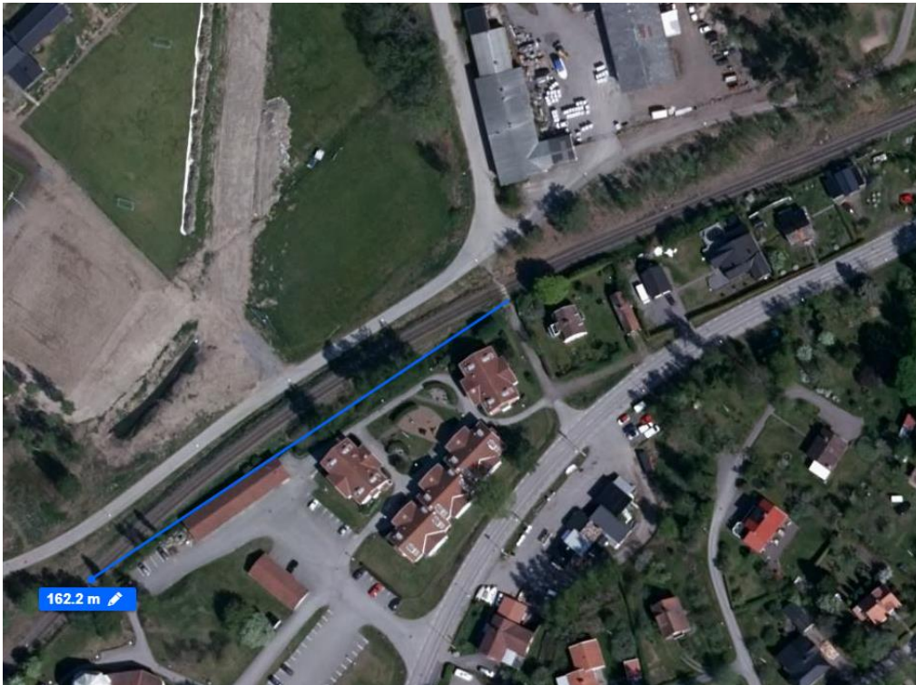
Figur 7: Siktlinje vid plankorsning.
