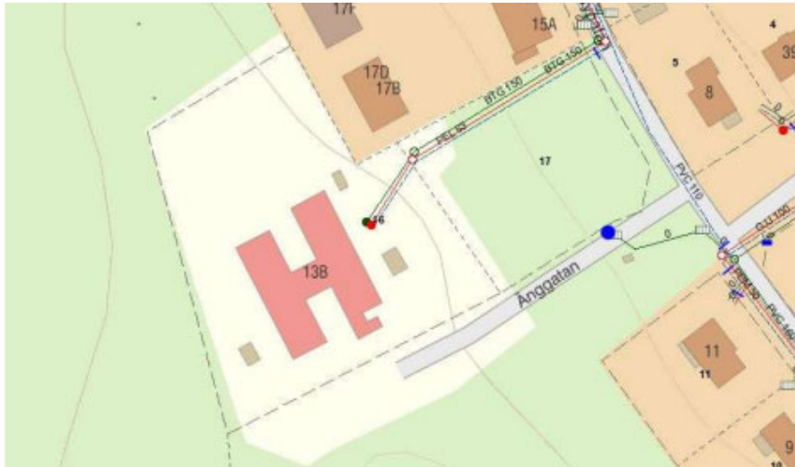
Figur 9. Befintliga VA-ledningar, inklusive dagvattenledningar.
