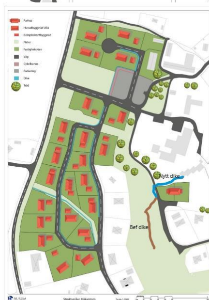
Figur 33: Strukturkiss över föreslagen fastighetsindelning med placering av byggnader. Strukturkissen visualiserar planområdet vid maximal exploatering. Ritad av Aorum Fastigheter AB (2022).
